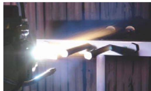
Vue d'une projection plasma APS, un des savoir-faire de l'équipe du laboratoire ICB à l'UTBM.
