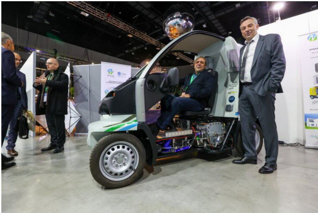
Le véhicule de démonstration MHYTIC de Mincatec fonctionne avec de l'hydrogène stocké sous la forme de poudre dans un réservoir compact qu'on voit sous le siège du passager. Photo Lionel Vadam
