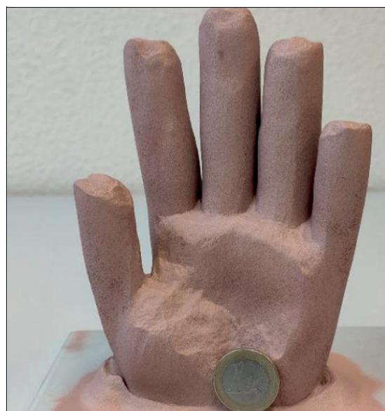
**La main de 2,2 kg, pièce complexe réalisée par projection à froid de minuscules particules d'alliage de cuivre.** Photos DR/UTBM
