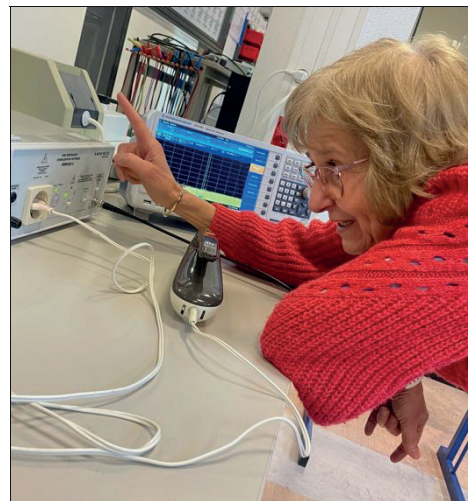
Béatrice Bouriot règle son analyseur de spectre pour tester notre couteau à viande électrique des années 70. Il ne passera pas le test de conformité aux normes d'aujourd'hui.
