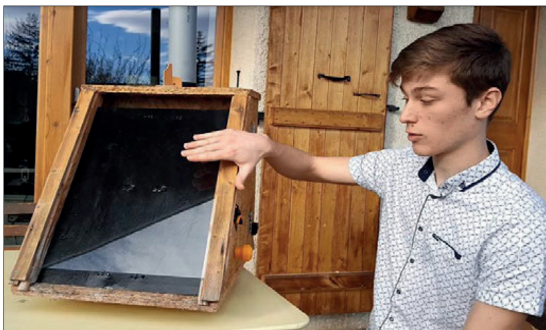
Léo Laveau, 17 ans, a inventé un séchoir solaire pour déshydrater les fruits en suivant automatiquement la trajectoire du soleil. Photo Progrès/Fabienne PYTHON
