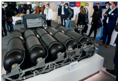
Quand le réservoir fonctionne à la pression 350 bars, il est configuré pour résister à 800/900 bars. Photo ER/Michael DESPREZ
