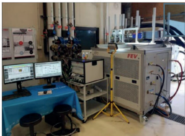
Hyban est capable de tester des piles à combustible jusque 120 kW, soit la puissance nécessaire pour équiper un poids lourd à hydrogène. Photo ER/Aurélien BRETON
