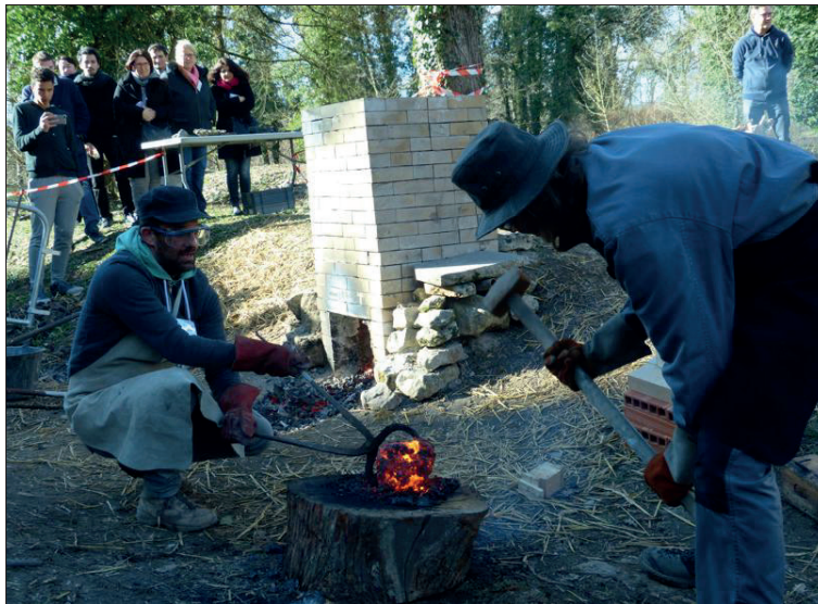
À la sortie du bas fourneau, le bloc de fer est martelé sur un billot en bois pour le débarrasser de ses impuretés. Photo ER/Isabelle PETITLAURENT
