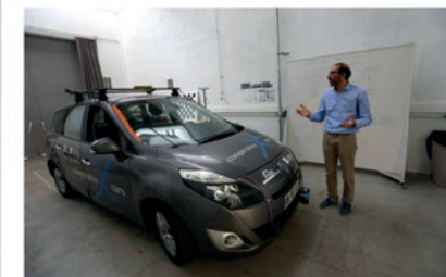
Le pôle montbéliardais de l'UTBM conduit d'importants travaux sur le véhicule autonome intelligent comme sur cette voiture blindée de capteurs pour analyser son environnement.
