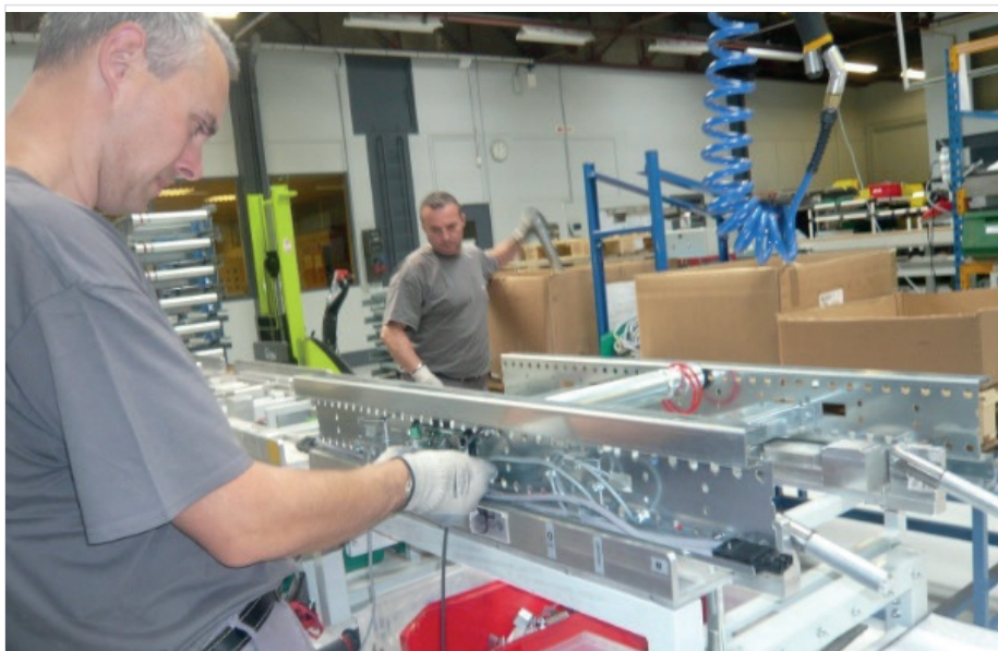
Montage des convoyeurs dans les ateliers de Ladoix-Serrigny. ©Traces Ecrites.
