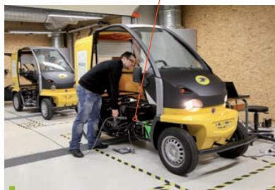
Ces prototypes zéro émission, baptisés «MobyPost», sont munis d'un réservoir à hydrogène très basse pression (trois bars) et d'une pile à combustible qui leur procurent une autonomie de 40 à 50 km. Ces quadricycles sont destinés aux centres de distribution de courrier d'Audincourt et de Perrigny (Franche Comté).
