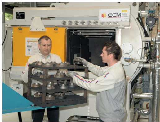
■ Implanté sur le site de Belchamp, ce four permet d'améliorer les performances techniques et la robustesse de certaines pièces.
