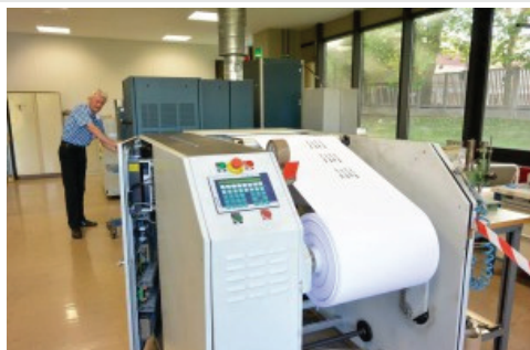
Un prototype de Nipson en cours de test : la vitesse d'impression est deux fois plus importante que celle commercialisée. © Pierre-Yves Ratti.
