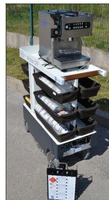
■ La nouvelle génération de minibar des CFF et son réservoir d'hydrogène, plus puissant et plus léger qu'une batterie.
