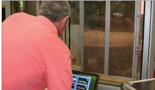
■ Le banc-test, développé depuis 2012 sur le site belfortain de l'UTBM, va permettre d'améliorer les pelleteuses de la société Liebherr.
