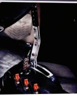
L'habitacle est dépouillé et dépourvu du moindre élément de confort. Les leviers de boîte de vitesses et de frein à main sont inédits et réalisés à l'unité. Quant aux petits rêtros, ils reposent sur des mâts en fibre de carbone!
