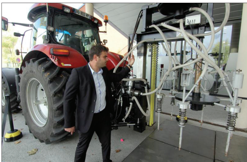
■ Conçu par la plateforme « Agroéquipements et agriculture durable » de l'établissement d'enseignement et de formation professionnelle agricoles de Vesoul, ce prototype permet de lutter contre la prolifération des campagnols en limitant l'utilisation de produits toxiques. Photo X. GORAU
