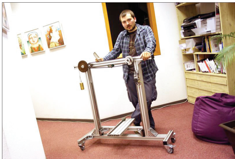
■ L'imprimante permettra de réaliser toutes sortes d'objets en plastique d'une contenance de 190 litres. En construction depuis septembre, elle devrait être opérationnelle d'ici juin. Photo ER
