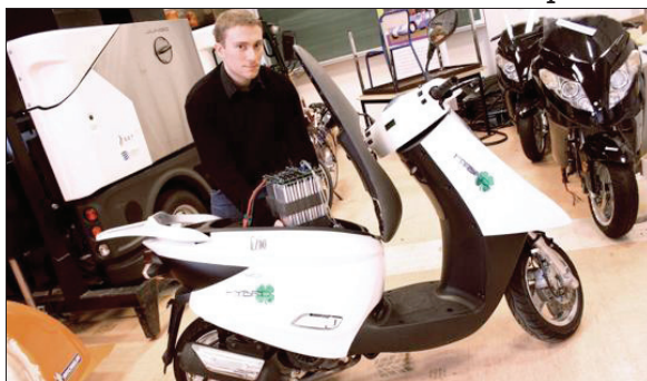
■ Des chercheurs de l'UTBM mettent au point un scooter hybride thermique électrique avec une batterie amovible.
