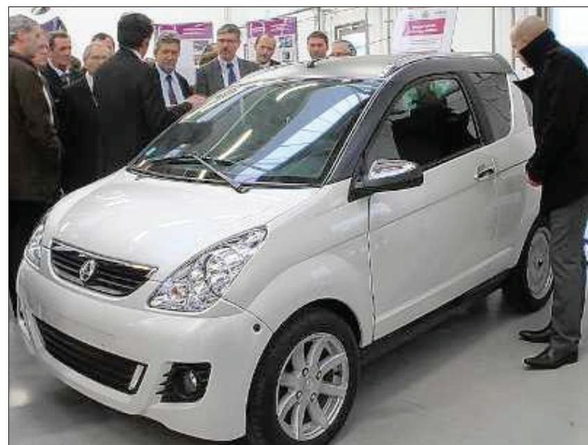
Phebus, un prototype de l'UFR-STGI, équipé d'un moteur thermique diesel à l'avant et de deux moteurs électriques dans les roues arrière. Photos Patricia Louis
