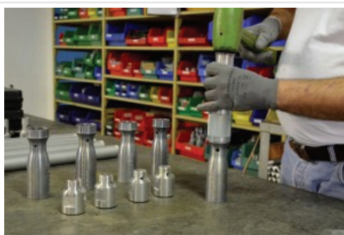
Une des opérations de montage du décapeur pneumatique.
