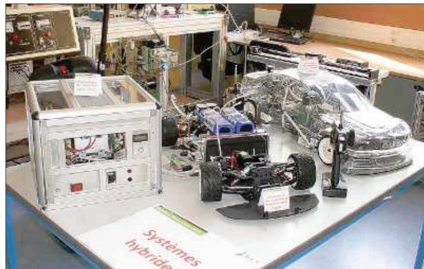
A gauche un groupe électrogène et à droite deux modèles réduits, tous équipés d'une pile à combustible pour fabriquer l'électricité nécessaire. Photos J.B.
