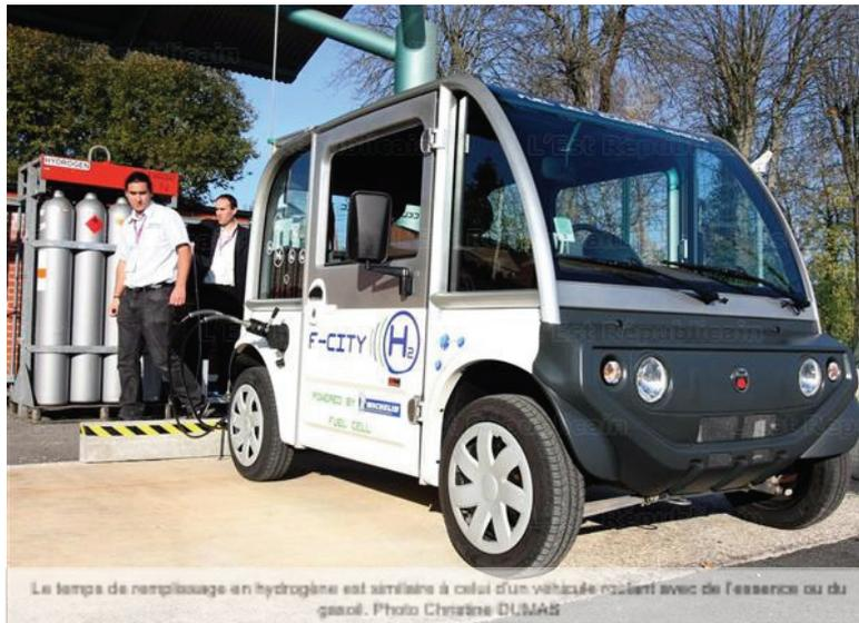
Le temps de remplissage en hydrogène est similaire à celui d'un véhicule roulant avec de l'essence ou du gasoil. Photo Christine DUMAS
