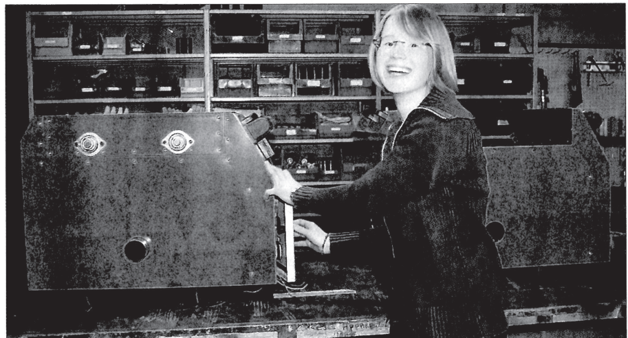
Aurélie Robert devant la « Blow'box » de l'entreprise Mabi, à Botans. Elle a travaillé à concevoir cet appareil, qui souffle de la ouate de cellulose pour l'isolation des logements. Photo Guillaume Minaux
